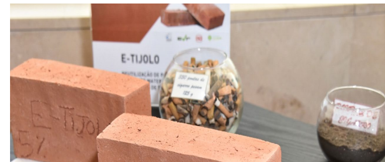
E.TIJOLO – aproveitamento de resíduos no fabrico de tijolo, com redução de energia
